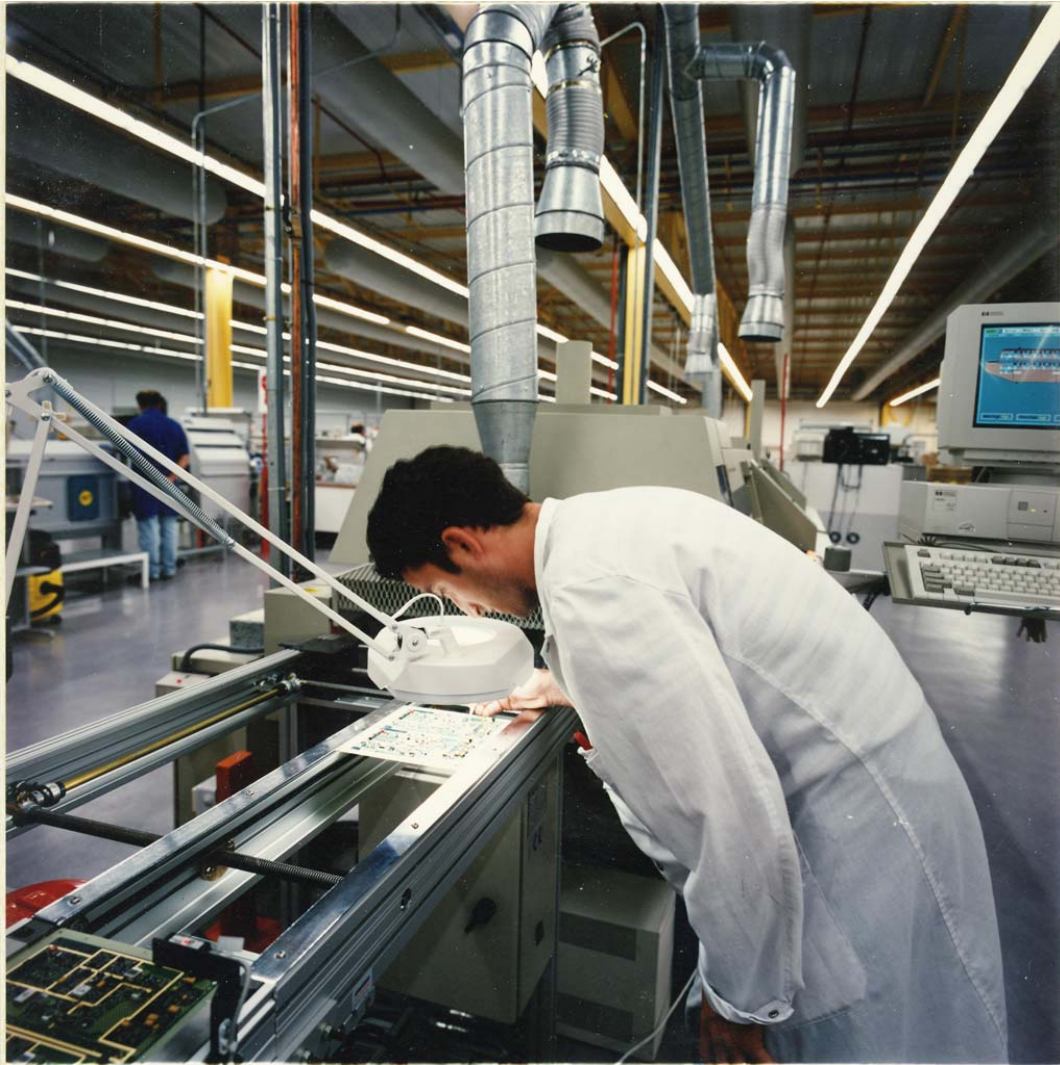
13. Entrada de placas a horno de atmósfera inerte para Soldadura por refusión de SMD's (Surface Mounted Devices)
