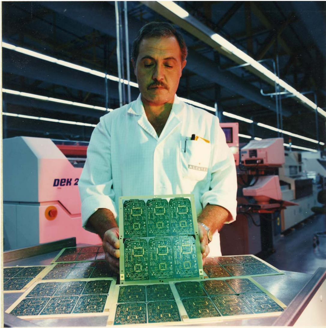
18. Multipanel de 6 circuitos impresos de teléfono DECT.
