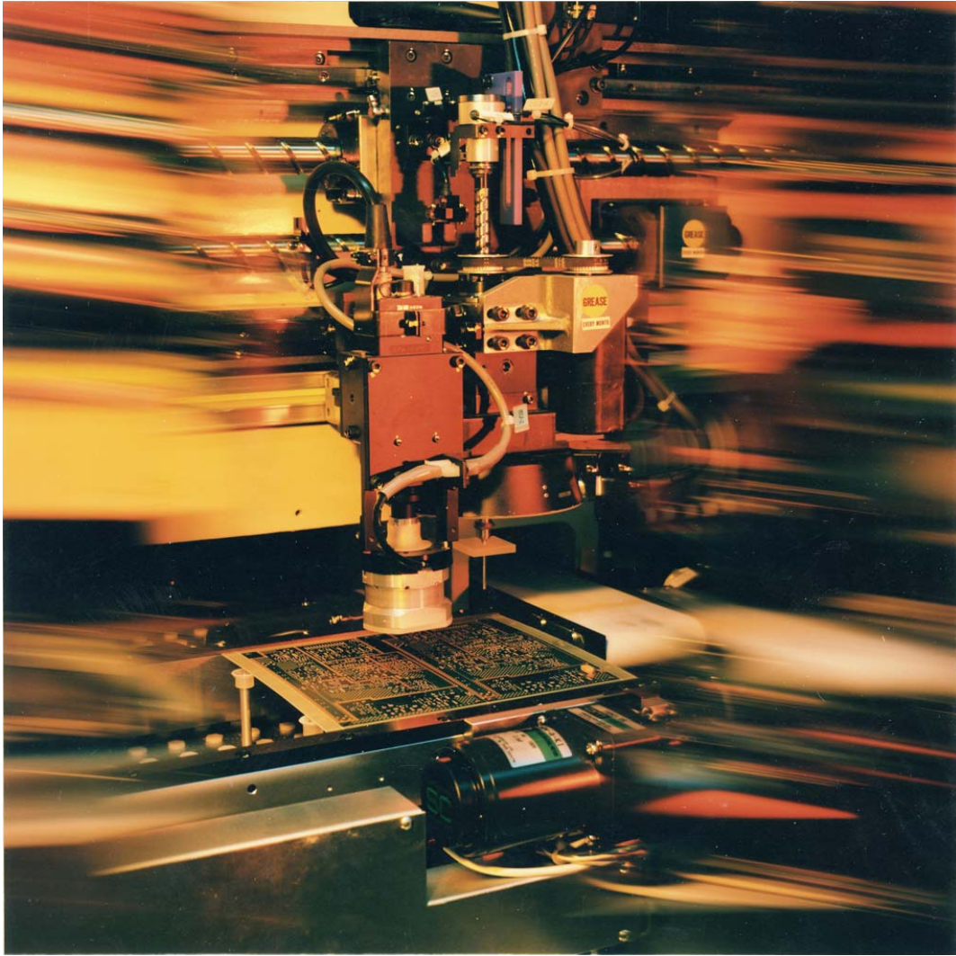
15. Detalle de cabezal de máquina Fuji IP de ensamble de SMD's (Surface Mounted Devices)
