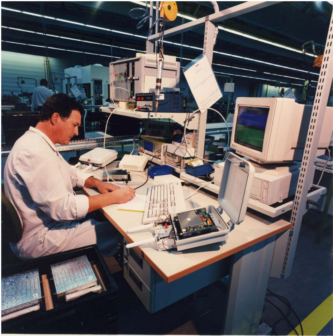
Puesto de reparación y prueba de estaciones base del sistema DECT en las instalaciones de Alcatel Citesa
