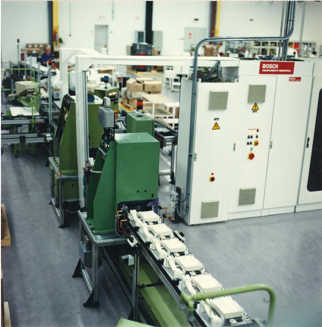
33. Puestos de prueba en automático del teléfono Forma
