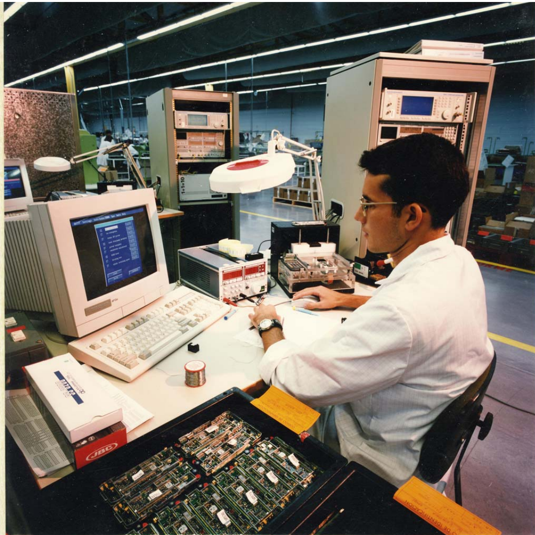
30. Ajuste y prueba manual de circuitos impresos ensamblados del teléfono DECT.
