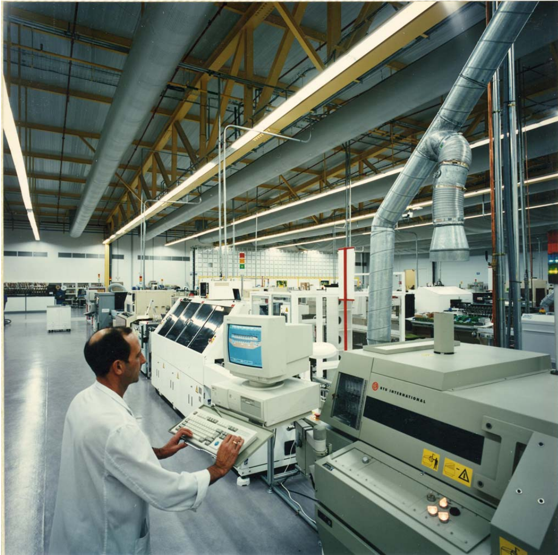
20. Vista del Taller de PBA's ( P rinted B oard A ssembly) (Ensamble de Circuitos Impresos). En primer término, horno de soldadura en atmósfera inerte.
