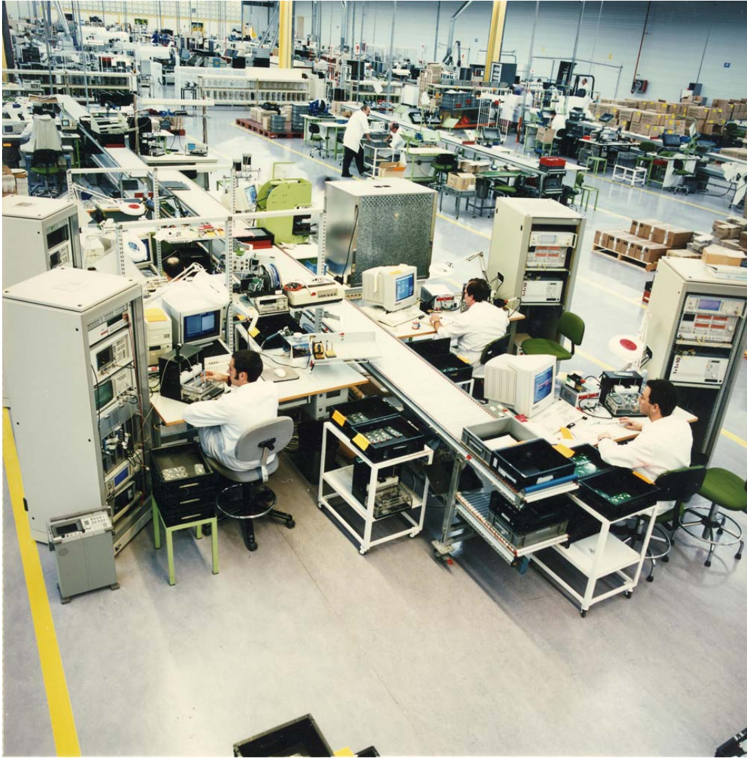
26. Línea de ajuste y prueba manual de placas de teléfonos inalámbricos
