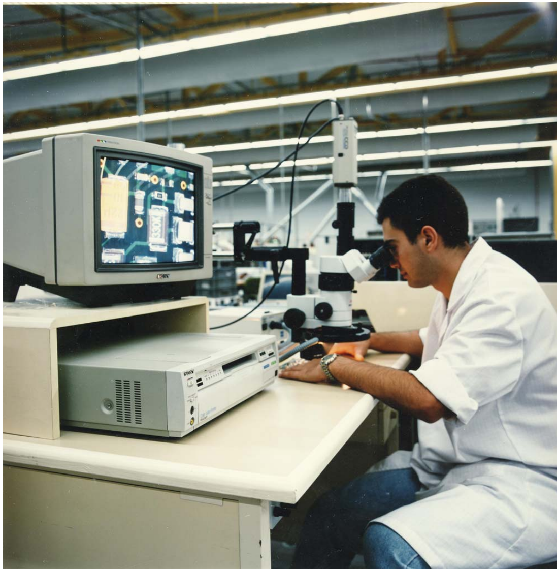
28. Microscopio para inspección de circuitos impresos con cámara para monitor
