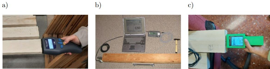
figura 36. Dispositivos empleados para clasificación de madera estructural. a) MTG. b) PLG [44]. c) TIK.
